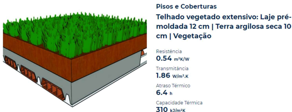
Figura 37 - Telhado ecológico.
